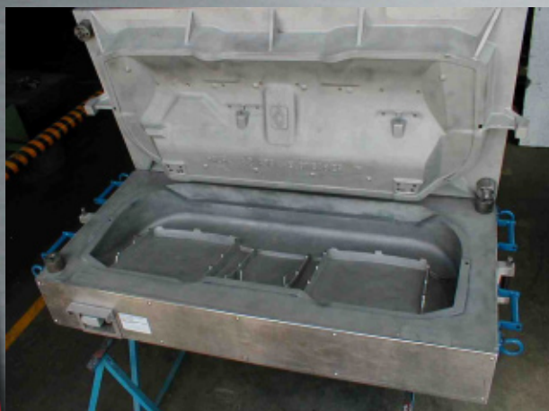
Moldes calefaccionados con resistencias eléctricas o por serpentín incorporado en la fundición
