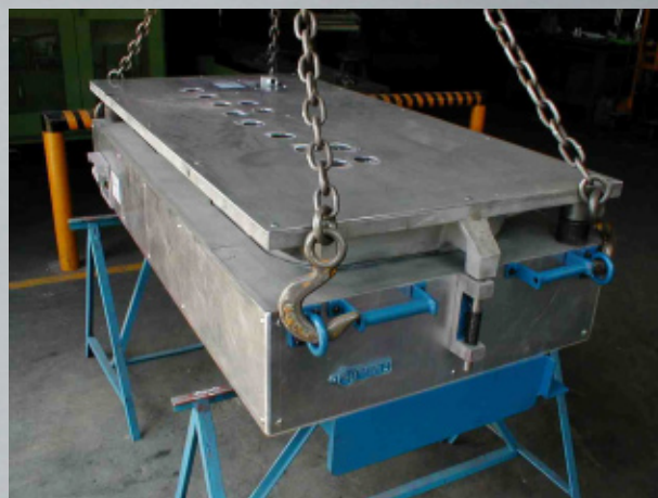
Moldes calefaccionados con resistencias eléctricas o por serpentín incorporado en la fundición
